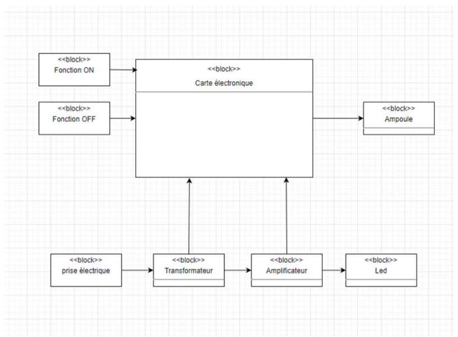
Le diagramme des blocs internes nous a permis de définir les échanges d'information, d'énergie et de matière entre les blocs du système pour son bon fonctionnement.
